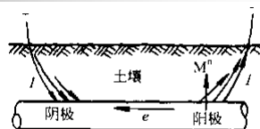
图 3-20 杂散电流引起的腐蚀
